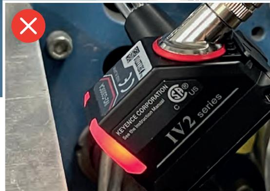
Die Kamera verfügt über eine integrierte Beleuchtung und eine automatische Fokuseinstellung. Inert rund 100 Millisekunden wird ein Bild gelesen und verarbeitet.
